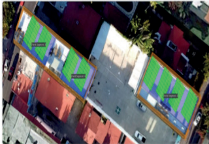
Figura 1. Sombras potenciales en zona de instalación de paneles fotovoltaicos
